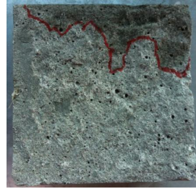
fig. 17 Indringingsfront bij normaal B35 3 dagen hoge druk waterspuiten
