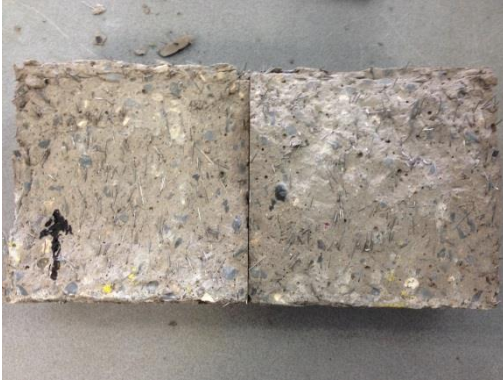
Fig. 16 Geen indringingsfront bij de geleverde UHSB kubussen beton 3 dagen hoge waterdruk
